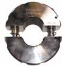
Pohled shora na závitový stahovák Hi-Force pro rychlou montáž
