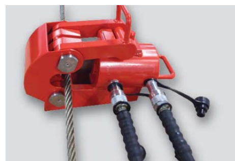
Krok 3: Zavřete řezací hlavu otočením zpět do výchozí polohy a zajistěte západkou.
