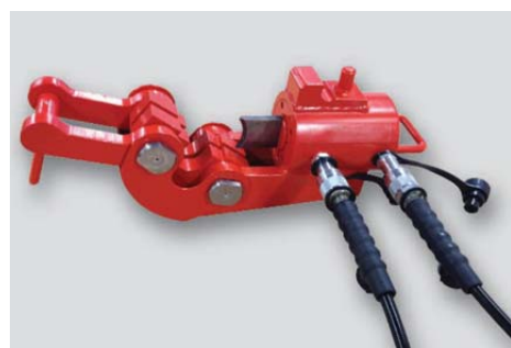
Krok 1: Otevřete řezačku otočením řezací hlavy vpřed.
