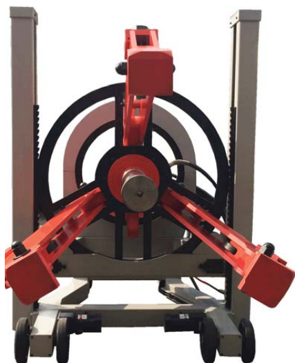
Samočinně centrováné čelisti stahováku s protiskluzovým mechanismem
